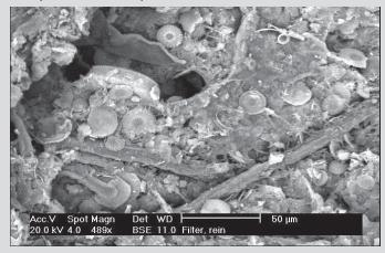
Vue microscopique d'une plaque filtrante profondeur: les structures circulaires sont dûes aux diatomées, les structures longues aux fibres celluloses.
