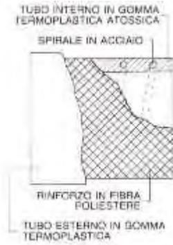
Tuyau en caoutchouc thermoplastique avec spirale en acier zincé à haute résistance avec renforcement en fil polyester. Structure et material à haute résistance à la courbure. Couleur: bleu à l'extérieur et blanc à l'intérieur.
